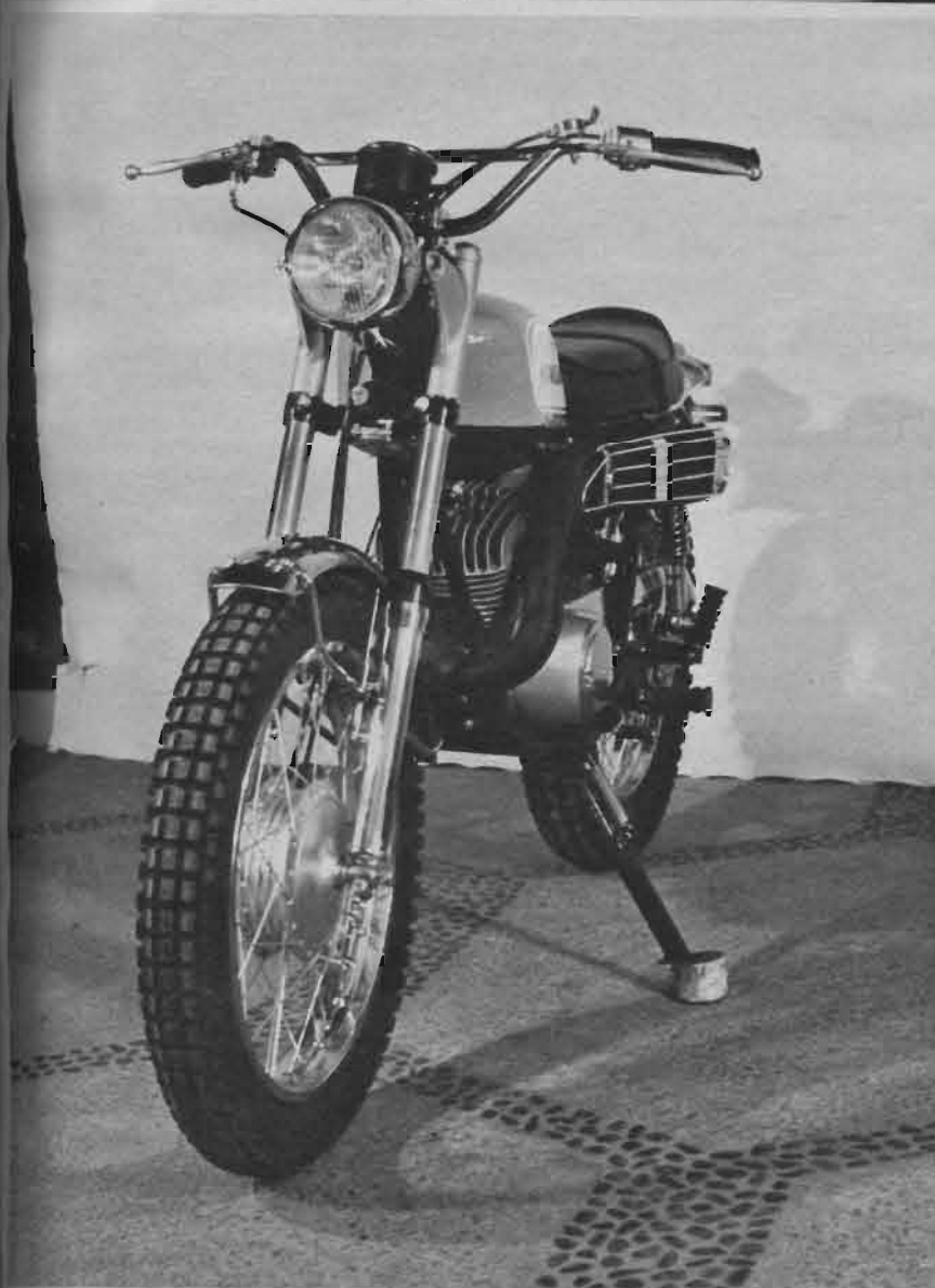
ダブルシートは横開閉式でシート下にはバッテリー 工具 オイルタンクなどが収まっている
