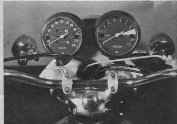
↑ 240km/hのスピードメーターと11,000rpmのタコメーターはライダーの視線に合わせて取り付けられている
