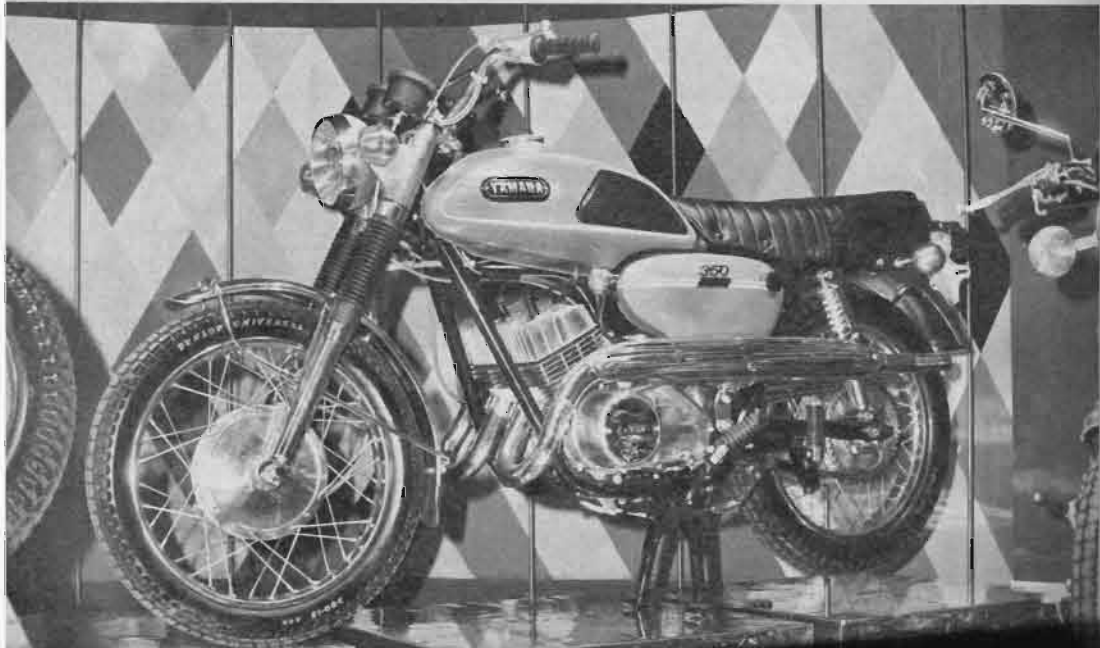
グランプリ350をベースに、アップマフラー、ダウンハンドルを装備して不整地用としたグランプリスクランプラー350。タイヤは標準車と同じく前三〇〇ー八後三三〇ー八であるが、バッテリーは独自のもの。
