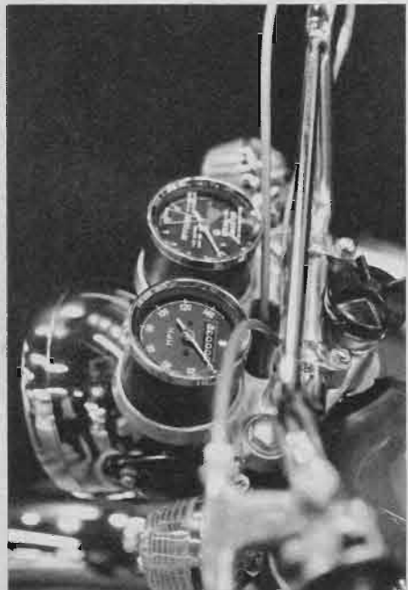
ヘッドランプとは別体のセパレートメーターはニューT250と同じものを装備。
