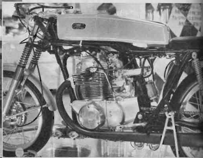
CB350をベースにしているとはいえ、「よりパワーを、よりスピードを！」の要求にこたえて、あらゆるところにチューニングされたパーツが組みこまれている。
