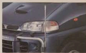
フラッグポール
