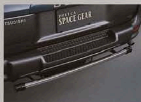
リアアンダーガードバー (4WD/4WDロング全車, ROYAL EXCEED/SUPER EXCEEDはクロムメッキ)
