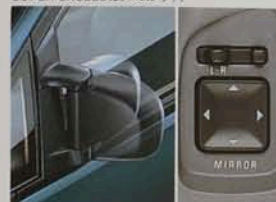
電動格納式リモコンアミラー (4WD SUPER EXCEED, 4WDロング全車, 2WDロング EXCEED/XR)
