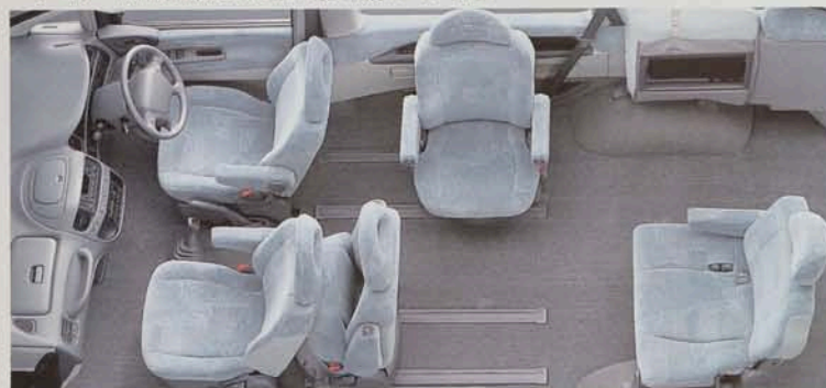
■セカンドシート右を90度横向き回転*左をチップアップ&前方スライド。ラウンジ感覚の空間として、フィールドでの拠点スペースに最適。
