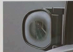
ヒーター付ドアミラー (4WD SUPER EXCEED, 4WDロング全車)
