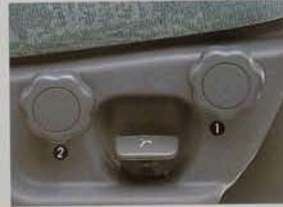
運転席デュアルハイトアジャスター ① 前座ハイト上下調整 ② 後座ハイト上下調整 (EXCEED/XR、4WD SUPER EXCEED)
