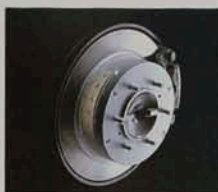
リヤドラムインディスクブレーキ(4WD) PHOTO:説明のため、一部を省略しています。
