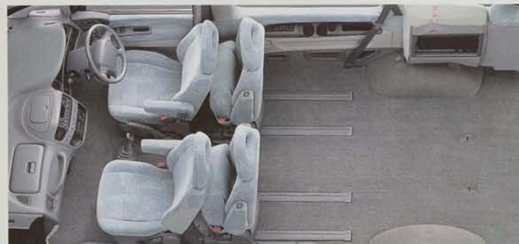
■セカンドシート左右をチップアップ&前方スライド。サードシート左右をはねあげれば、約1.8m長(ロングは約2.2m)のビッグなラゲジスペースが出現。
