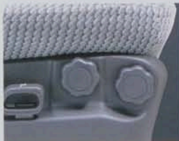
運転席デュアルハイトアジャスターシート ①前部ハイト上下調整 ②後部ハイト上下調整 (XGを除くメタルトップ全車、JトップワイドZS、SUPER EXCEED系とGシリーズを除くミッドルーフ系全車、キックアップルーフワイド全車)
