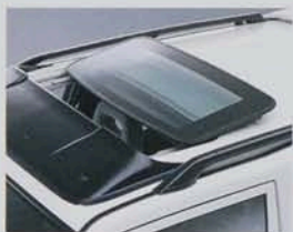
電動チルト&スライドガラスサンルーフ (メタルトップワイドZR-I)
