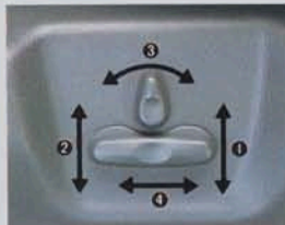
運転席4ウェイパワーシート ①前部ハイト上下調整 ②後部ハイト上下調整 ③リクライニング前後調整 ④スライド前後調整 (ミッドルーフワイドSUPER EXCEED-Z、SUPER EXCEED)
