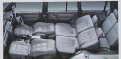
フルフラットシート(第1/2席、第2/3席) (ミッドルーフ系全車、XEバンを除くキックアップルーフ系全車、Gシリーズは第1/2席のみ) Photo:ミッドルーフワイドSUPER EXCEED-Z
