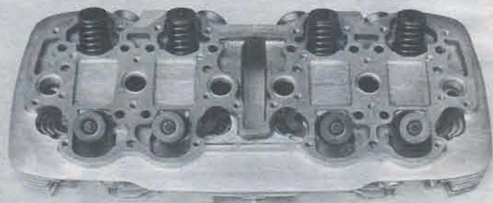
シリンダヘッドのバルブ側。バルブの外径は吸気弁32mm、排気弁28mm。バルブスプリングはもろろんだダブルスプリング。
